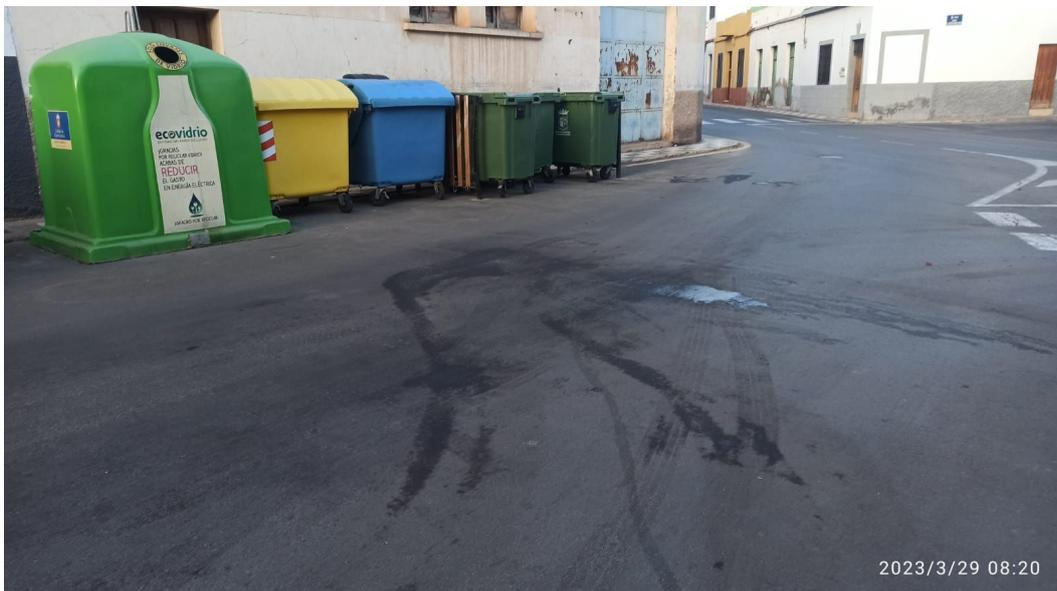
**FALTA:** Derrame de líquidos hidráulico de los camiones del servicio.09/05/2023.
